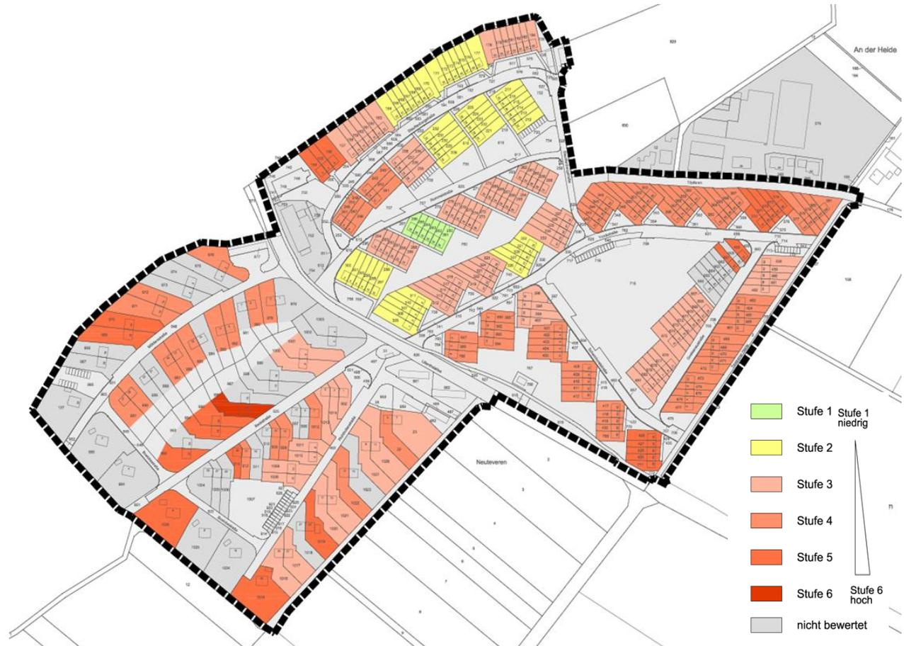
Abb. 45: Plan Nr. 11 – Geschätzter Sanierungsaufwand
