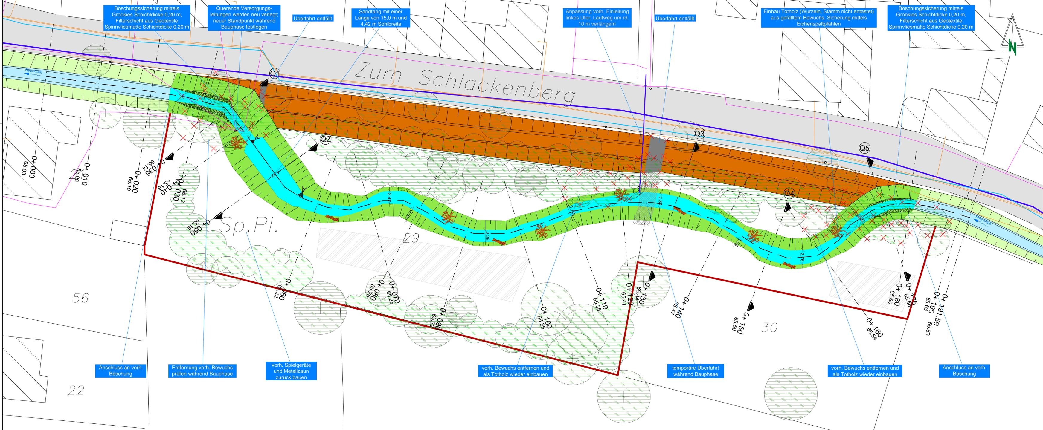
Böschungssicherung mittels Grobkies Schichtdicke 0,20 m, Filterschicht aus Geotextile Spinnvliesmatte Schichtdicke 0,20 m
