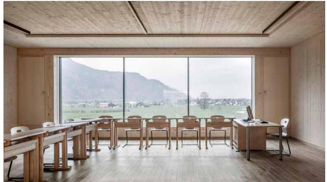
Wände aus Brettsperrholz, Decken als Brettstapeldecken, holzsichtig
