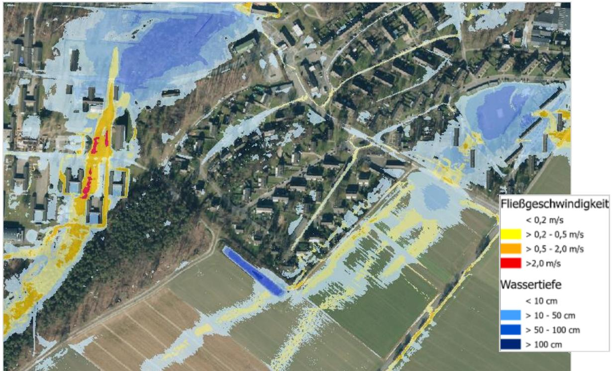
Abb. 6: Starkregenhinweiskarte, extremer Starkregen (90 mm/h), Quelle:LANUV NRW 2022
